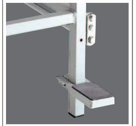
Die Pressvorrichtung ist bei diesem Modell in das Untergestell integriert und wird per Fußpedal betätigt.
